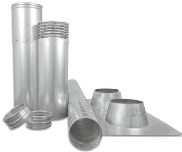
Ein komplettes Dachdurchführungsset besteht aus 2 isolierten Durchführungen, 2 Dacheindeckungen, 1 Dachhaube (Fortluft), 1 Lamellenhaube, 2 Nippeln und 3 m Wickelfalzrohr.
