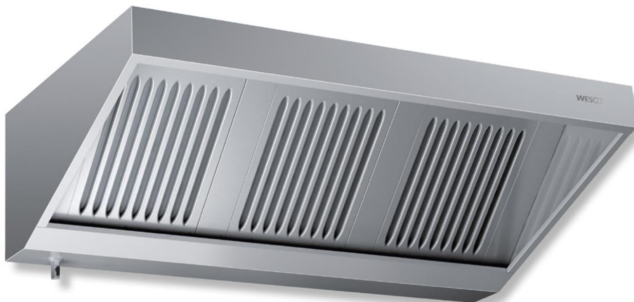
La hotte gusto sans ventilateur se caractérise par un volume de captation particulièrement efficace. Sa carrosserie taillée en biais, étanche à l'air, en acier inoxydable fin, augmente le volume de captation et offre une liberté ergonomique accrue. Les filtres à labyrinthe filtrent les vapeurs de cuisson et piègent les graisses dans le collecteur étanche prévu à cet effet.
