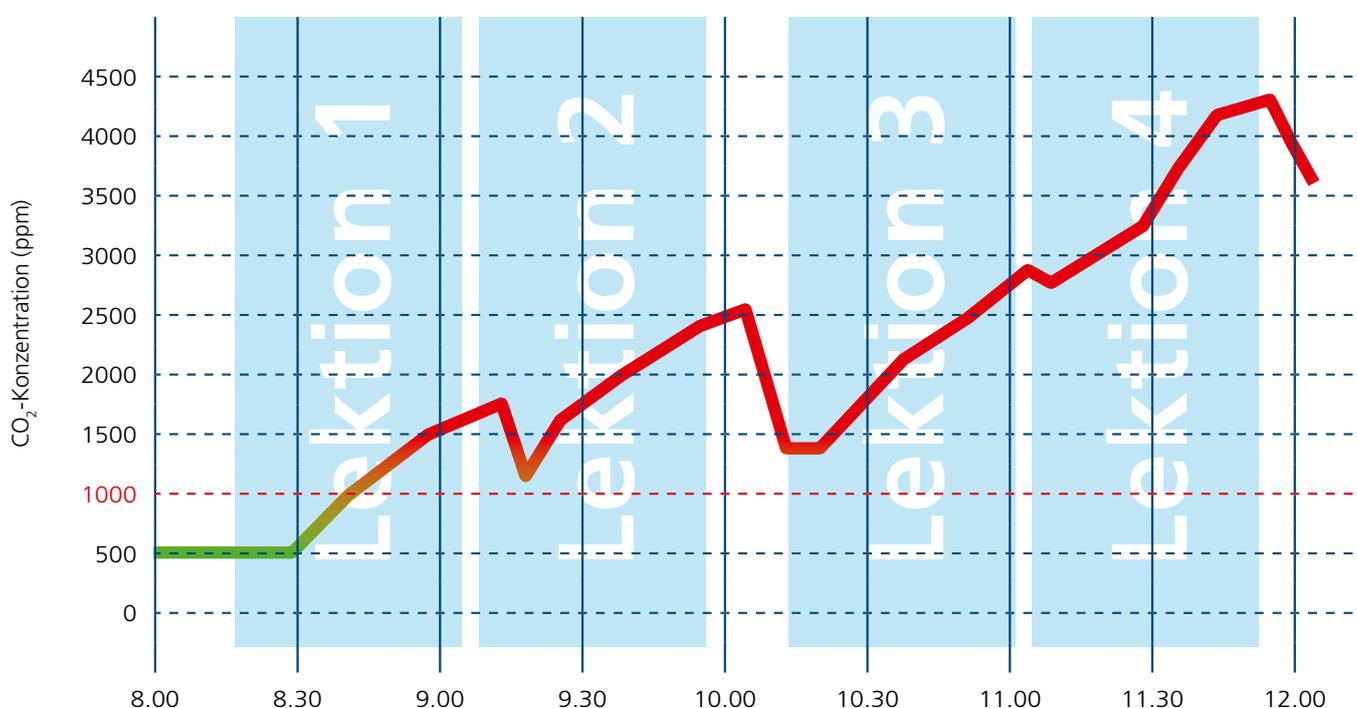
Beispiel: Entwicklung der CO<sub>2</sub>-Konzentration während eines Vormittags. Kurzes Lüften um 9 Uhr, längeres Lüften um 10 Uhr und keine Pausenlüftung um 11 Uhr. Die Luftwerte bewegen sich konstant über den empfohlenen Werten.
